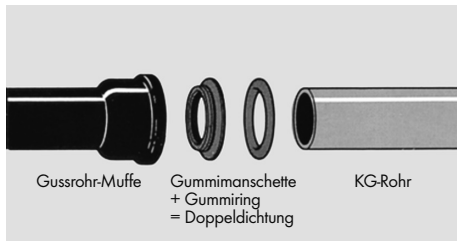
KG-Anschluss an Gussrohr-Muffe mit Doppeldichtung
