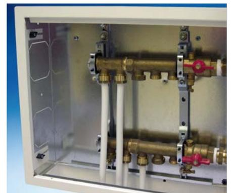
**3** Verteiler für Warm- und Kalt- wasser mit Verteilerhalter und 1" Kugelhahn. Das Entleerungsventil des Kugelhahns muss auf der zum Verteiler weisenden Seite eingebaut sein.
