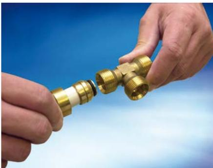
**4** Das Rohr mit dem Stützkörper bis zum Anschlag in den Fittinggrundkörper schieben. Kunststoffscheibe schützt vor Kontaktkorrosion.
