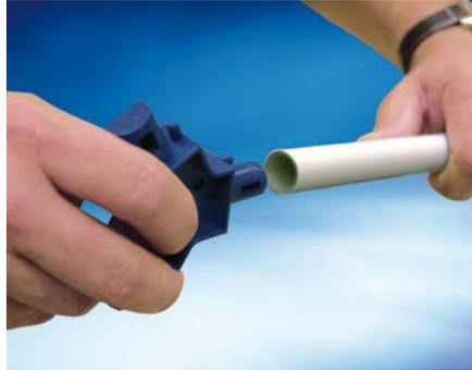
**2** Den Kalibrierdorn bis zum Anschlag in das Rohrende schieben und mehrfach drehen. Der Rohrquerschnitt wird hierdurch kalibriert.
