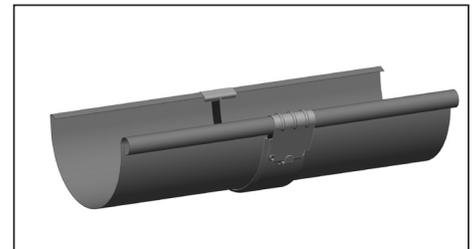
Sicherungsklammer aufbiegen, Wulstklammer über Wulst legen und nach unten einschnappen lassen. Sicherungsklammer zubiegen und mit Lasche fixieren. Fehlt der Schnappeffekt, nochmals Rinnenform überprüfen und korrigieren.
