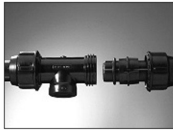
Fitting aufschrauben – Über- wurfmutter, Klemmring und Dichtung auf das Rohrende schieben.
